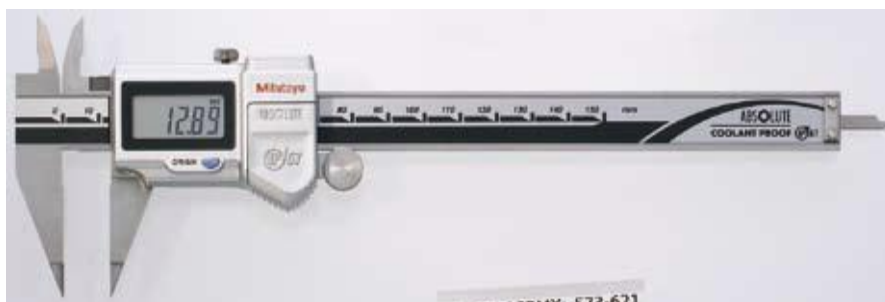
с) штангенциркуль серии 573 с заостренными измерительными губками
